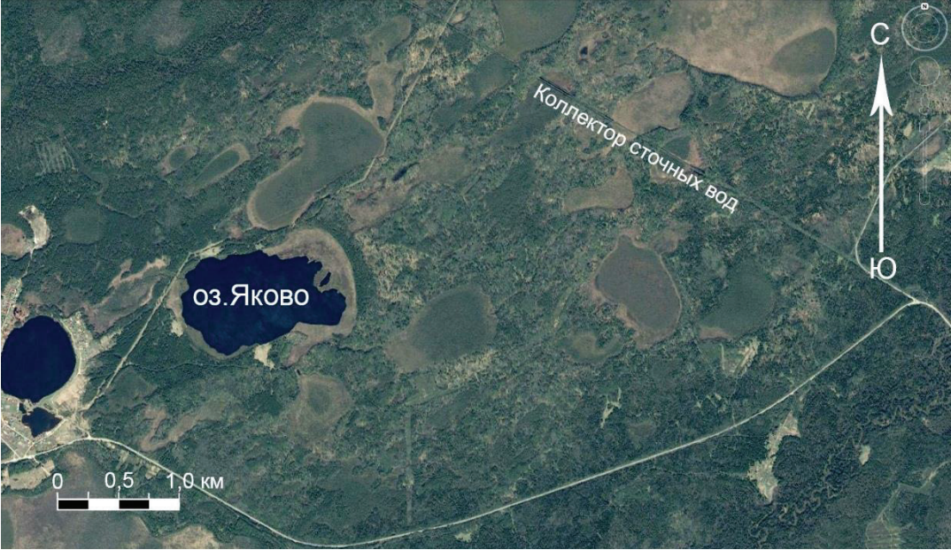
Рисунок 6. Расположение коллектора сточных вод с очистных сооружений г.Томска относительно озера Яково.
